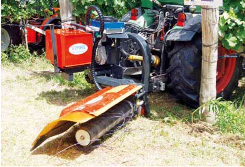
Bürstengerät zur Unterstockpflege. Der Unterstockbereich nach dem Einsatz mit einem Bürstengerät.
