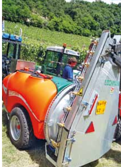
Sprühgerät mit Injektordüsen und Luftaustrittssperre.
