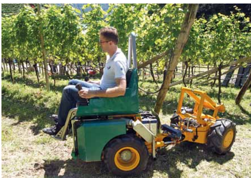
Prototyp eines Geräteträgers für Steillagen.
