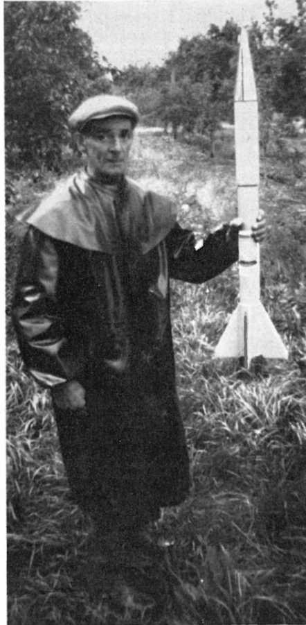
Die in Südtirol verwendeten Hagelraketen sind reine Explosionsraketen; sie bestehen aus einer Treibladung (Schwarzpulver) und einem Sprengkopf (800 g Chedit). Steighöhe zirka 2000 m.
