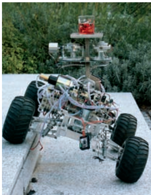
Dank der ausgeklügelten Kreiseltechnik bleibt die Bühne in der Waagrechten.
