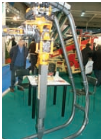
Mit der hydraulischen Zange am Tellerrand kann die Säule mühelos ins vorgedrückte Loch gestellt werden.
